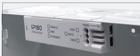
IP180 Instalat într-o cutie metalică
